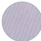
**Ripstrick** – Rechts/Rechts Ware, Vorder- und Rückseite des Stoffes sehen gleich aus, häufige Verwendung an Kragen und Armbündchen, hohe Elastizität, geringe Materialdichte, Unterscheidung zwischen 1x1 Ripp (abwechselnd links und rechts gestrickt) und 2x2 Ripp (abwechselnd 2 linke und 2 rechte Maschen)
