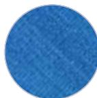
**Flammgarn (Slub)** – Verwendung von Garnen mit unterschiedlicher Dicke ergeben diesen Effekt
